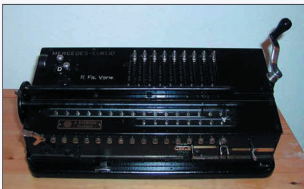
Арифмометр К.Гамана “Mercedes Euclid”
